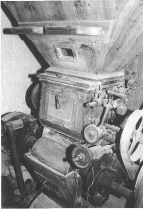
In der Mahlstube der Lexmühle steht heute noch ein einfacher Walzenstuhl, der den steinernen Mahlengang abgelöst hat. Beim Walzenstuhl besorgten zwei geriffelte Stahlwalzen statt der sich drehenden Steine den Mahlvorgang. Foto: Fritz Fellner
