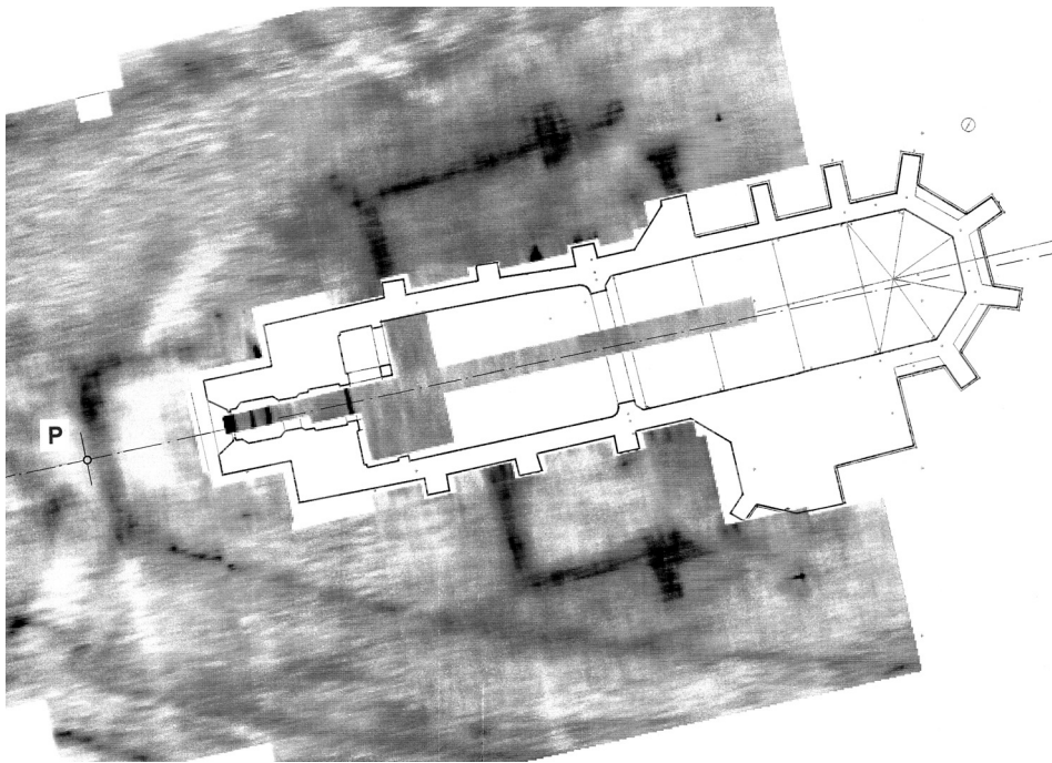
Abb. 14: Marchegg, Stadtpfarrkirche, Grundriss der ehemaligen Anlage mit Portalpunkt P, Georadar - Prospektion, M 1 : 500. (Archeo Prospections® 1998, Zentralanstalt für Meteorologie und Geodynamik, Wien).
