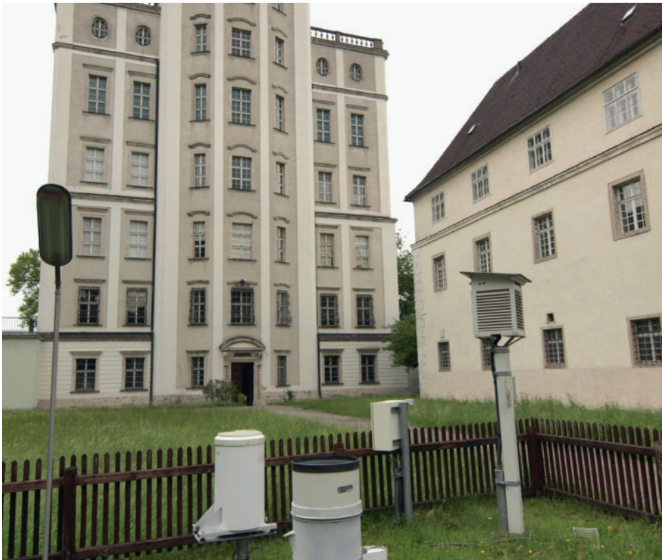
Abb. 9: Als Wettergarten eingezäunter Bereich im Konventgarten mit Ombrometer und genormter Wetterhütte für Thermometer, Taupunktmessgerät und Hygrometer
