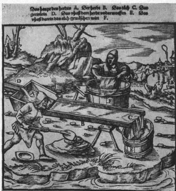
Abb. 2: Flußgoldgewinnung mittels eines tuchbedeckten Waschherdes. Holzschnitt aus G. Agricola: Vom Berg- werk XII Bücher. Das acht buch. Basel 1557. Lichtbild: D. S. Landesbildstelle, Linz
