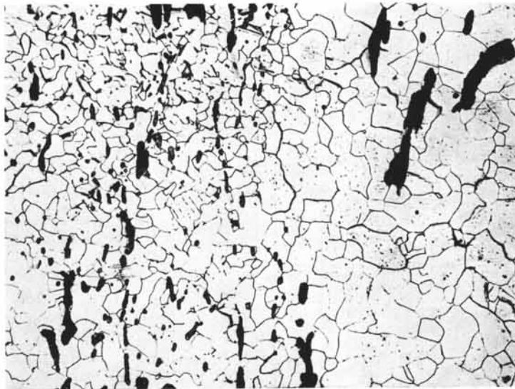
3 Mikrogefüge (Ferrit, zeilenförmige Schlackeneinschlüsse)
