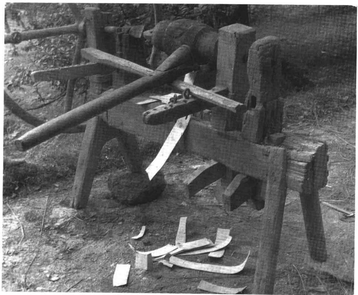
5 „Spangoß“ (Eigentümer: H. Neißl). Der Prügel ist zwischen Dorn und Mitnehmer eingespannt, auf dem Gleitbalken liegt das Späneisen, wie es beim Spänedrehen gehalten wurde
