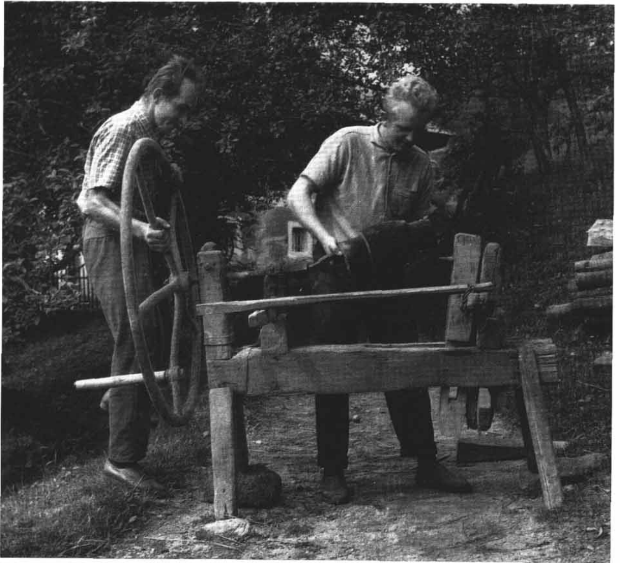
2 „Spangoaß“ – Einspannen des Prügels, hier einer alten, auf Späne zu verarbeitenden Radnabe. Der Mitnehmer (links vom Prügel) und der Dorn (rechts) sind gut zu sehen
