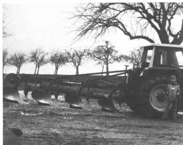
Vierschariger Anbaupflug, ein heute alltägliches Bild zur Zeit der Bodenbearbeitung. Pflug und Traktor sind oberösterreichische Erzeugnisse.
