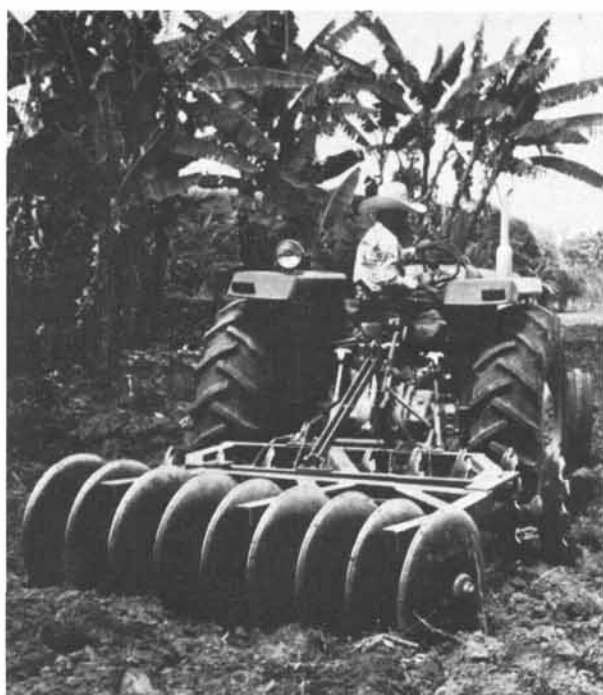
Traktor mit Scheibenpflug in Mexiko. Ähnliche Geräte, die Scheibeneggen, werden bei uns nicht mehr verwendet.
