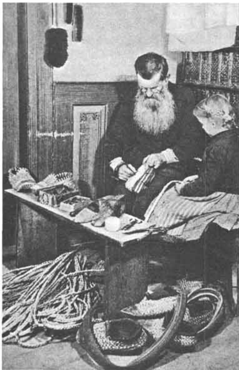
Ein Schwarzwälder Strohschuhflechter aus dem Elztal, BRD. Auf Vorrat gefertigte Strohzöpfe liegen unter der Werkbank, davor fertige Schuhe und zerschnittene Fahrradreifen. In den Kriegs- und Notzeiten unseres Jahrhunderts wurden abgefahrene Gummireifen oft zu Schuhsohlen verarbeitet, wohl auch hier zur Zeit der Wirtschaftskrise Anfang der dreißiger Jahre. (Postkarte „Winterhilfswerk des Deutschen Volkes (1933/34“.)
