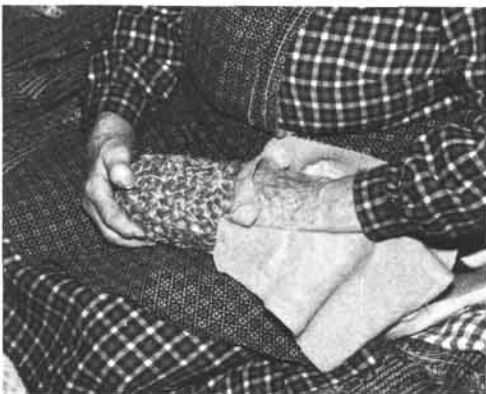
Das Futter wird in den Schuh geschoben und faltenlos eingenäht.
