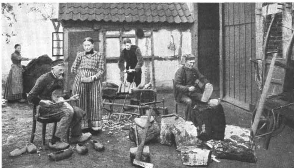
Westfälische Holzschuhmacher um 1905 bei der Arbeit. Birken- oder Pappelholzblöcke wurden aus Stämmen zersägt, die dazu verwendete große Zweimannsäge lehnt rechts am aufgerichteten Schubkarren. Vorn im Mittelgrund steht die Axt, mit der die Blöcke zur Weiterverarbeitung in handliche Stücke gespalten wurden. Diese Blöcke bearbeitet der rechts sitzende Bauer (?) mit seinem Beil zu den Rohlingen, die im Mittelgrund durch Aufbohren das Fußbett erhalten. Ihre endgültige äußere Gestalt bekommen die Schuhe links vorn mit dem Ziehmesser. Derartig gestellte Aufnahmen erfreuten sich um die Jahrhundertwende großer Beliebtheit bei Postkartensammlern. Wir verdanken diesen Fotos heute dokumentarische Darstellungen vergessener Arbeitsverfahren.
