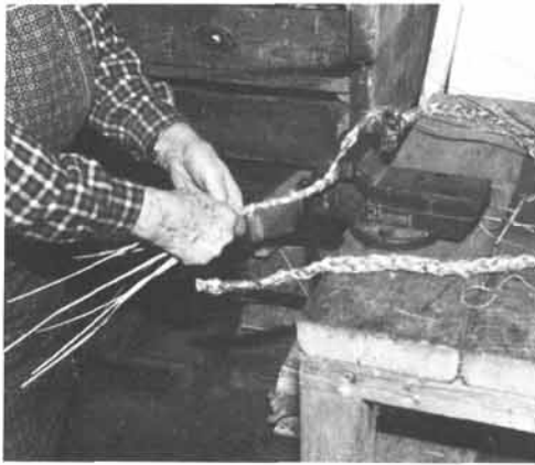
Der lange Strohzipf, aus dem die „Strohbat-scher“ zusammengenäht werden, findet wäh-rend des Flechtens sicheren Halt im Schraub-stock.
