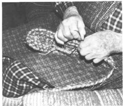
Die vierte und letzte Rundung des „Rasch“-Zipfes wird zur Fertigstellung der Sohle ver-näht.
