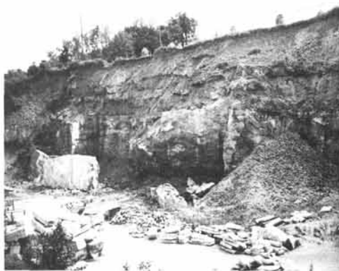
3. Abbau der Weißen Nagelfluh im Steinbruch Lärchenwald bei Kremsmünster. Die etwa 5 m mächtige kompakte Gesteinsbank wird von nur lagenweise verfestigter Grauer Nagelfluh überlagert, über der die ungeschichtete mit Blöcken durchsetzte Moräne der Mindeleiszeit folgt. Die in Abb. 1 dargestellte Moräne der Günzeiszeit liegt unter der Steinbruchsohle (Foto H. Kohl).
