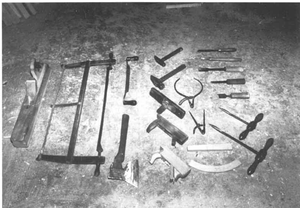
Werkzeuge zum Bau des Dreiradlers (Bezeichnungen von Wagnermeister Joseph Luger, Niederranna): Rauhbankhobel, Tischler-Gestellsäge mit Schnurspannung, Reifmesser (Reißmesser) zum Speichenschneiden, Handbeil, zwei Hämmer, Einlaufhobel (Spezialhobel, hergestellt vom Großvater Ludwig Luger, zur Bearbei- tung krummer Flächen, z. B. Felgeninnenseiten), Doppelhobel, Schropphobel, Greifzirkel zum Abgreifen der Nabe an der Drehbank, Stechzirkel zum Anreißen der Nabenform, Speichenlehre, Felgenlehre zum Sägen der Felgen des Dreiradlers auf der Drehbank, Drehmeißel für die Drehbank, Drehröhre für die Drehbank, Füge- eisen für Ausnehmungen der Nabe, Lochbeitel für Ausnehmungen der Nabe, Stemmeisen für Ausnehm- ungen der Nabe, zwei Handbohrer für Nabenmitte und Felgenlöcher.
