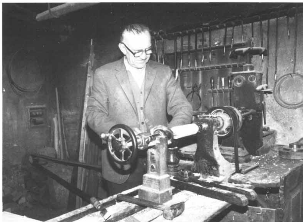
Riemengetriebene Drehbank für Radnaben und andere Drehteile.
