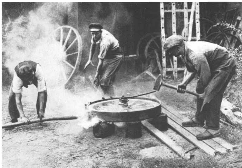
Der heiße Eisenreifen wird auf die Holzfelge geschlagen.
