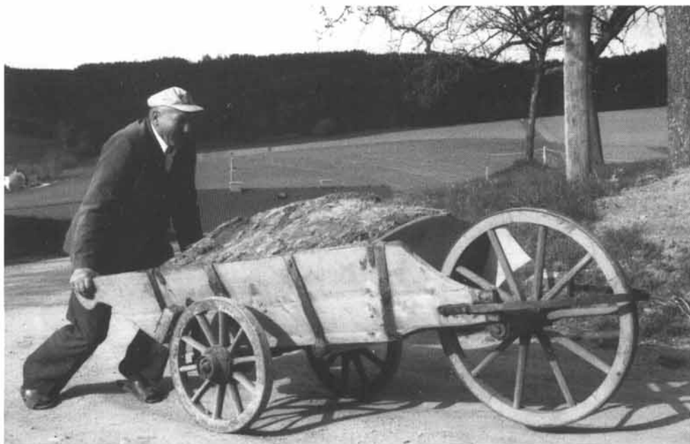
Durch Niederdrücken der hinteren Griffe hebt sich das Vorderrad, und der schwerbeladene Wagen läßt sich leicht auf den Hinterrädern drehen (Franz Wimmer, Emmersdorf bei Hofkirchen i. M.).
