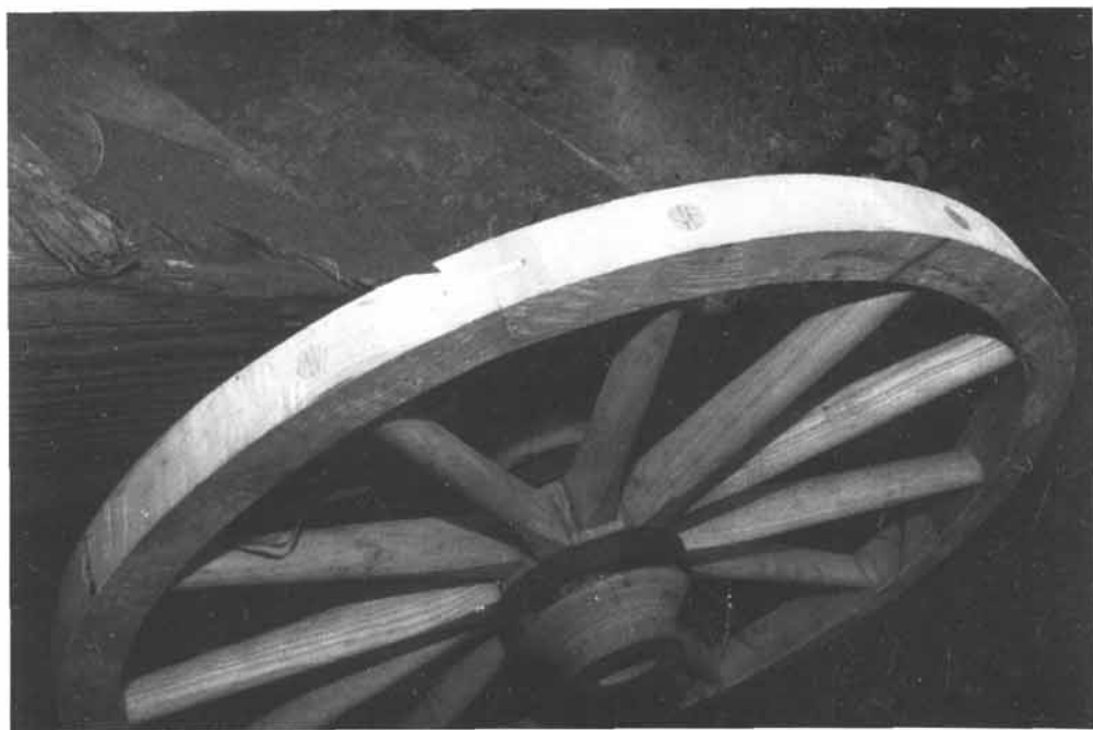
Sind alle Felgen montiert, werden sie durch hölzerne oder eiserne Keile miteinander verbunden, auf dem Bild durch einen Holzkeil.
