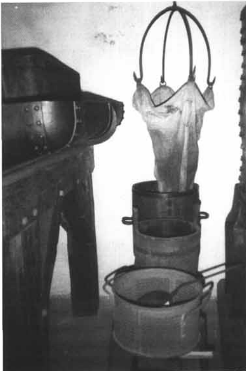
Kleines Kühlschiff, Trübsack und Hefesieb mit Hefelöffel im Brauereimuseum.
