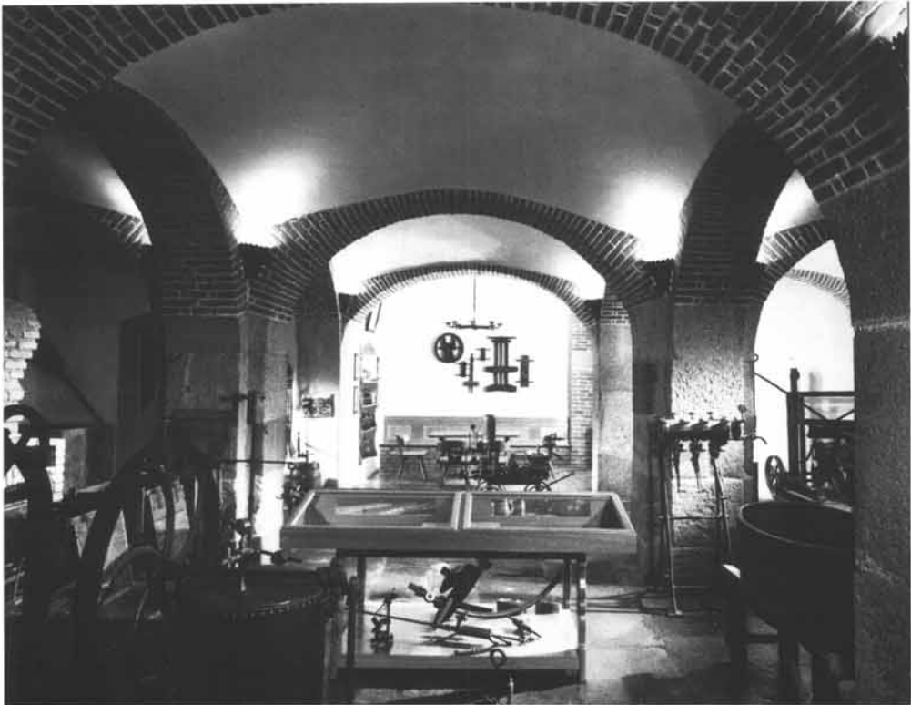
Blick in das Brauereimuseum Linz: rechts Flaschenwaschbottich, daneben Flaschenfüller, an dem drei Flaschen gleichzeitig abgefüllt werden konnten. In der Mitte Objekte aus der Binderei.
