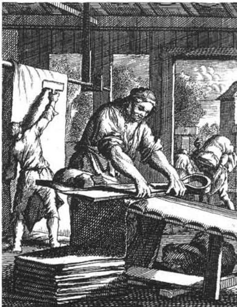
Abb. 5: „De Droogscheerder“, der Tuchschere nach Luyken, 1736. Der Lieger seiner Tuchschere ist durch Bleiklötze beschwert. Im Hintergrund ein Tuchrauer.
