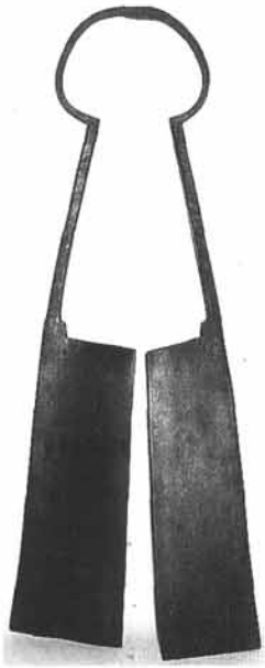
Abb. 6: Die 1,36 m lange Tuchschere im Museum Innviertler Volkskundehaus der Stadt Ried im Innkreis, wohl aus dem frühen 19. Jahrhundert. Das linke Blatt ist der Lieger, das rechte der Läufer.
