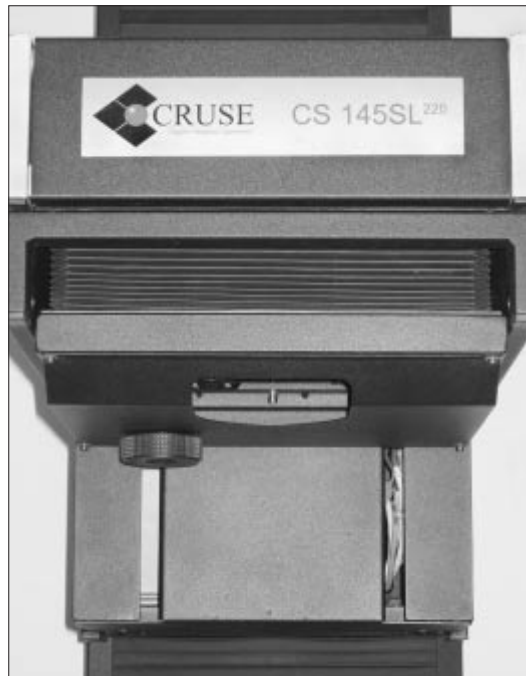
Abb. 2: Der Scankopf des Reproscanners (Foto: Riegler).
