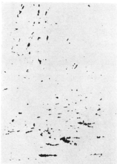
Bild 3: Römisches Eisenmesser, Einschlus- konzentration im Kern. Schliff ungeätzt. Vergrößerung: 80fach.
