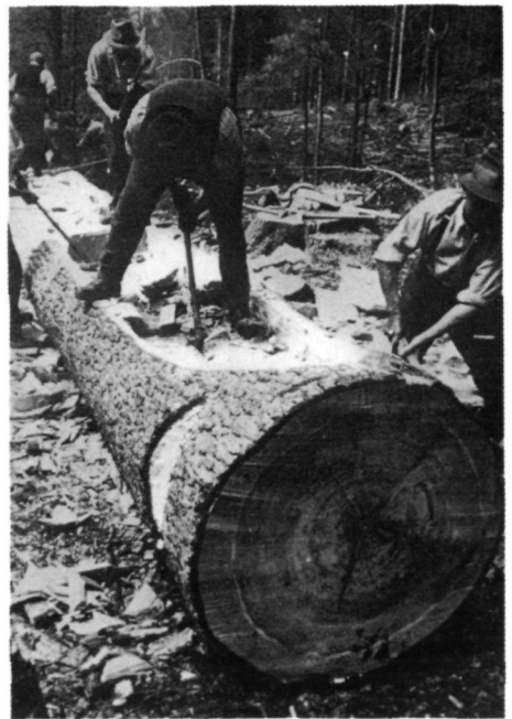
Abb. 6 Auskeilen des Überholzes und Arbeit mit dem "Ebntextl".
