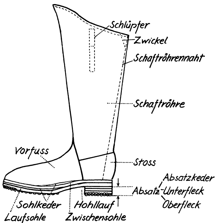
Textabbildung 6: Seitenansicht eines Wasserstiefels mit innerer und äußerer Wassernaht (Schema)
