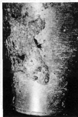
Abb. 3: Stark korrodierte Flickstelle am Gefäßkörper.
