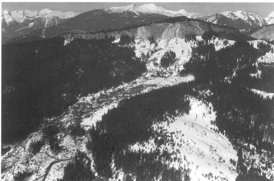
Abb. 139: Felsstürze Zwerchwand bei Goisern, Salzkammergut. Oben: Felsstürze 1978 und 1980. Aufnahme P. Baumgartner; unten: Durch die abgestürzten Felsmassen ausgelöster Erd-Schutt-Strom mit anschließender Mure 1982. Aufnahme H. SORDIAN
