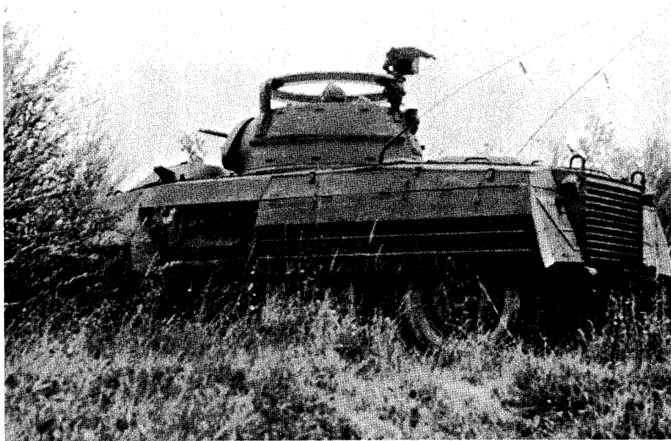
Abb. 33: Panzerspähwagen M 8 der B-Gendarmerie bei dem Manöver um Wels im Herbst 1951. Deutlich erkennbar: die 3,7-cm-KWK ist durch ein MG ersetzt
